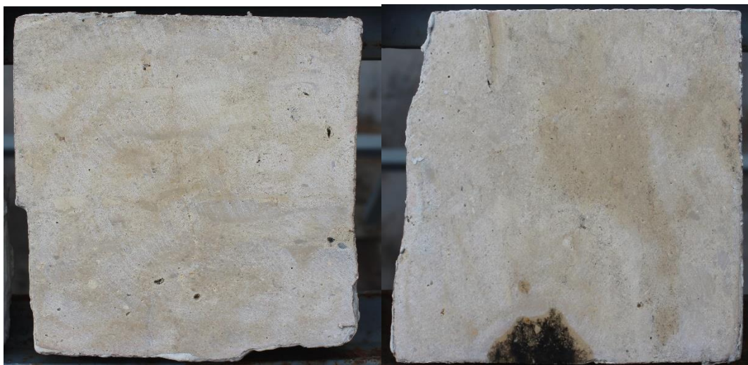
Figura 1 - Amostras com e sem aplicação de nanorrevestimento de \text{TiO}_2 , contaminadas com microrganismos e submetidas ao intemperismo natural durante nove meses
